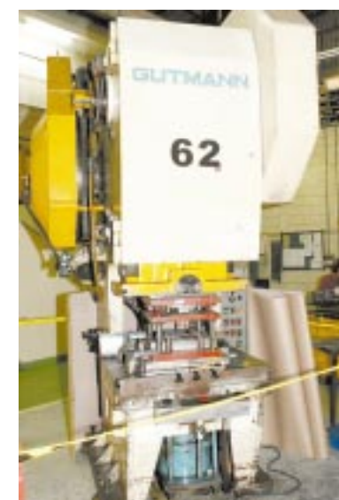
A prensa só foi liberada depois de ganhar as proteções exigidas por lei
