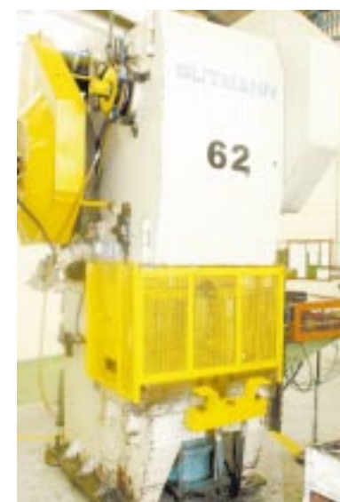
A prensa só foi liberada depois de ganhar as proteções exigidas por lei
