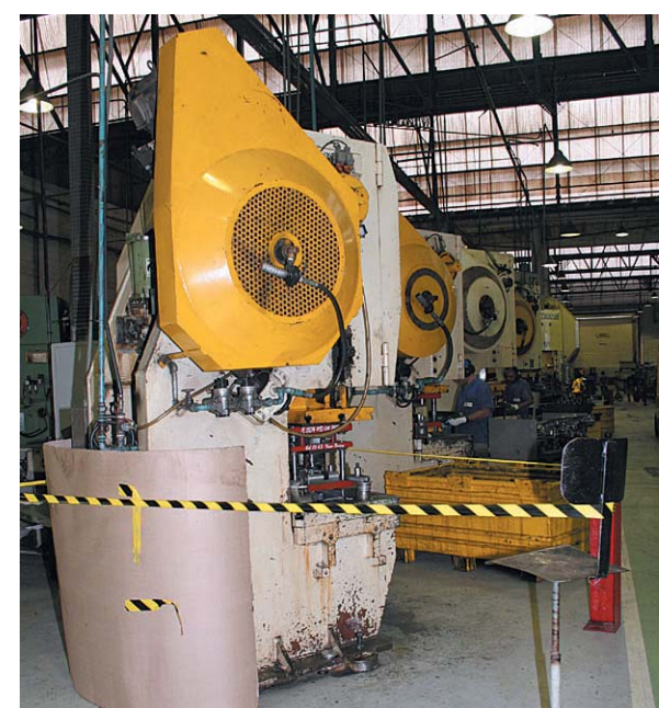
Máquina sem proteção interditada pela ação dos cipeiros
